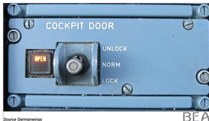
Figura 5. Interruptor de control de la puerta
